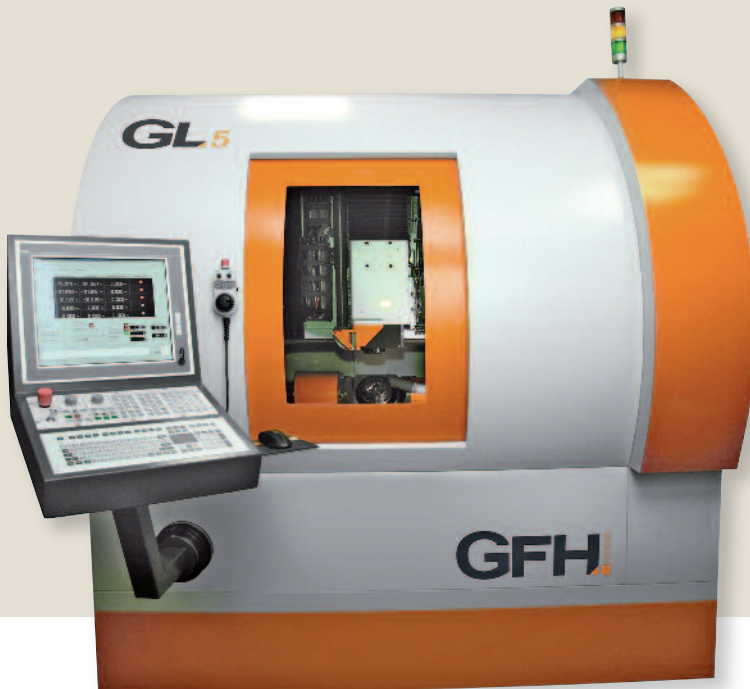
Bild 2. Die GL.evo verbindet einen Ultrakurzpuls-Laser mit einer Trepanier- und einer Festoptik, um damit hochpräzise Schnitte im Mikrobereich erzeugen zu können. Die Konturtoleranzen bewegen sich dabei unter 10\ \mu\text{m} , der Mittenrauwert der Oberflächen liegt bei normaler Geschwindigkeit unter 0,3\ \mu\text{m}
