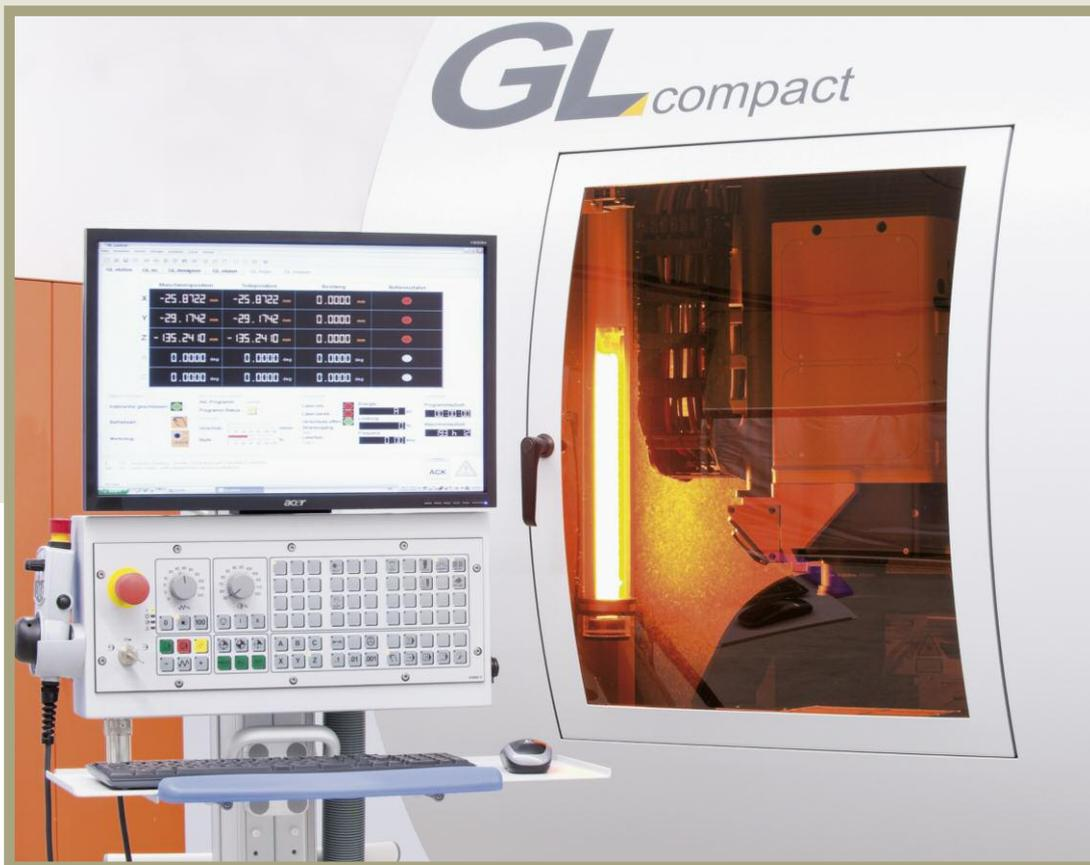
Bild 2. Anhand der Bahngeschwindigkeitsinformationen der CNC berechnet das System in Echtzeit die geeignete Intervalllänge für den jeweiligen Bearbeitungsabschnitt und reguliert den Laser entsprechend nach
