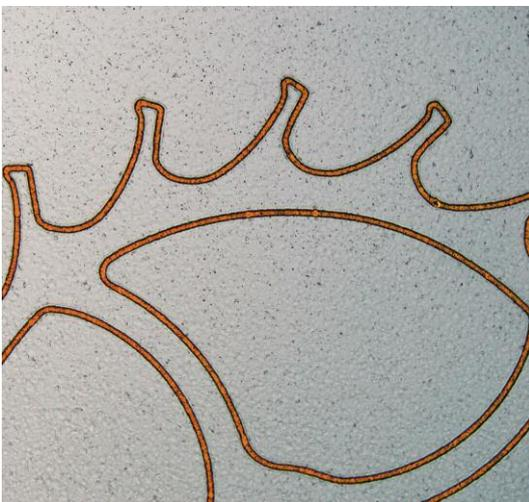
Bild 4. Das variable Pulssteuerungssystem erlaubt auch bei sehr temperatursensitiven Materialien einen homogenen Abtrag. Beispielsweise kann damit eine 100 nm dünne Nickelschicht bearbeitet werden, ohne die darunterliegende Trägerfolie zu beschädigen
