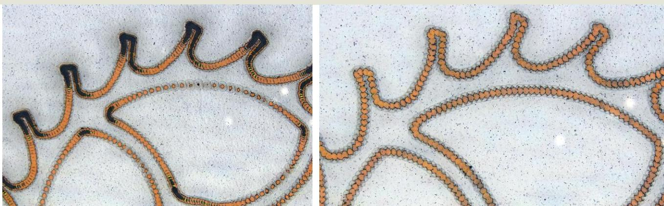
**Bild 1. Mit dem Pulse-on-Demand-Verfahren von GFH wird die Pulsfrequenz zu jeder Zeit entsprechend der aktuellen Bahngeschwindigkeit reguliert. So lassen sich äquidistante Pulsabstände in jeder Kontur erreichen (links ohne und rechts mit Pulse-on-Demand-Bearbeitung)**
