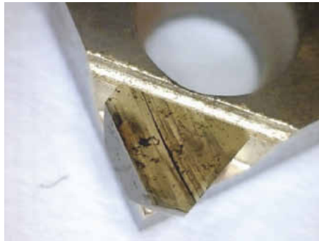
Zu den Merkmalen monokristalliner Diamantschneiden gehört eine extrem scharfe und schartenfreie Schneidkante. Bilder: Becker
