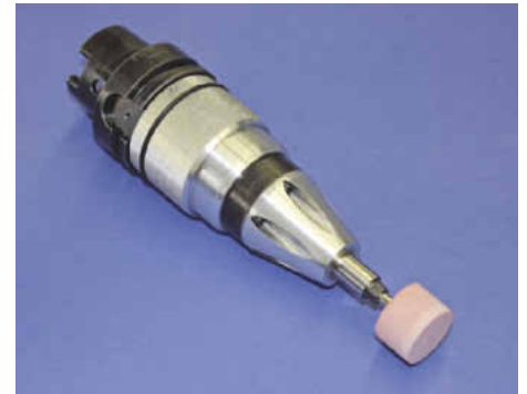
Das von Aachener Forschern entwickelte Polierwerkzeug lässt sich über die HSK-Schnittstelle auch in ein CNC-Bearbeitungszentrum einwechseln.
