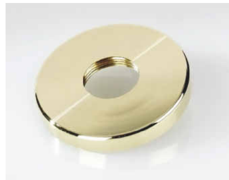
Ohne Nacharbeit erzeugen MKD-Werkzeuge – wie hier an der Fase des Messing-Rings zu sehen – spiegelnde Oberflächen.
