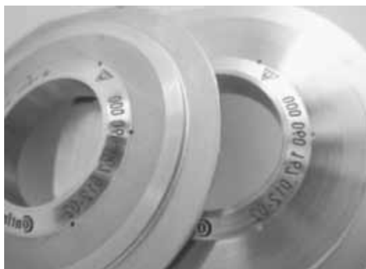
Zwei Werkzeugeinsätze im Vergleich - rechts unbearbeitet, links mittels Ultrakurzpuls-Laser poliert. Bilder: GFH
