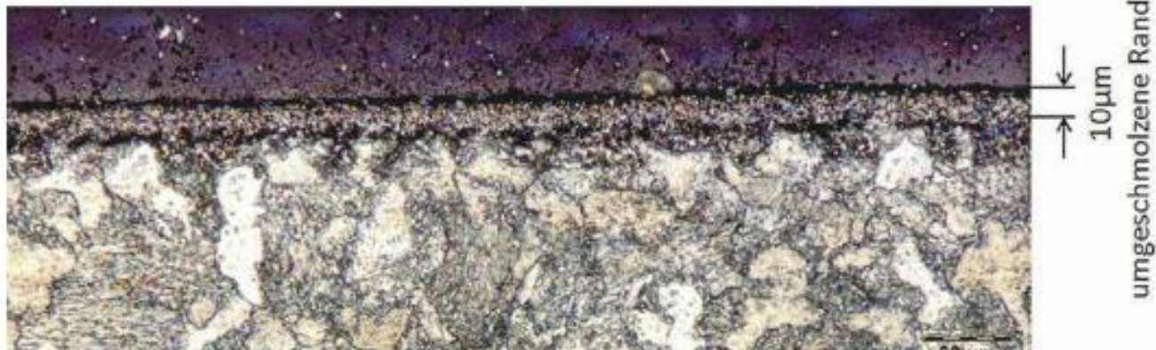
Die Umschmelzzone in der Randschicht dieser laserpolierten Probe beträgt circa 10 \mu\text{m} Quelle: GFH
