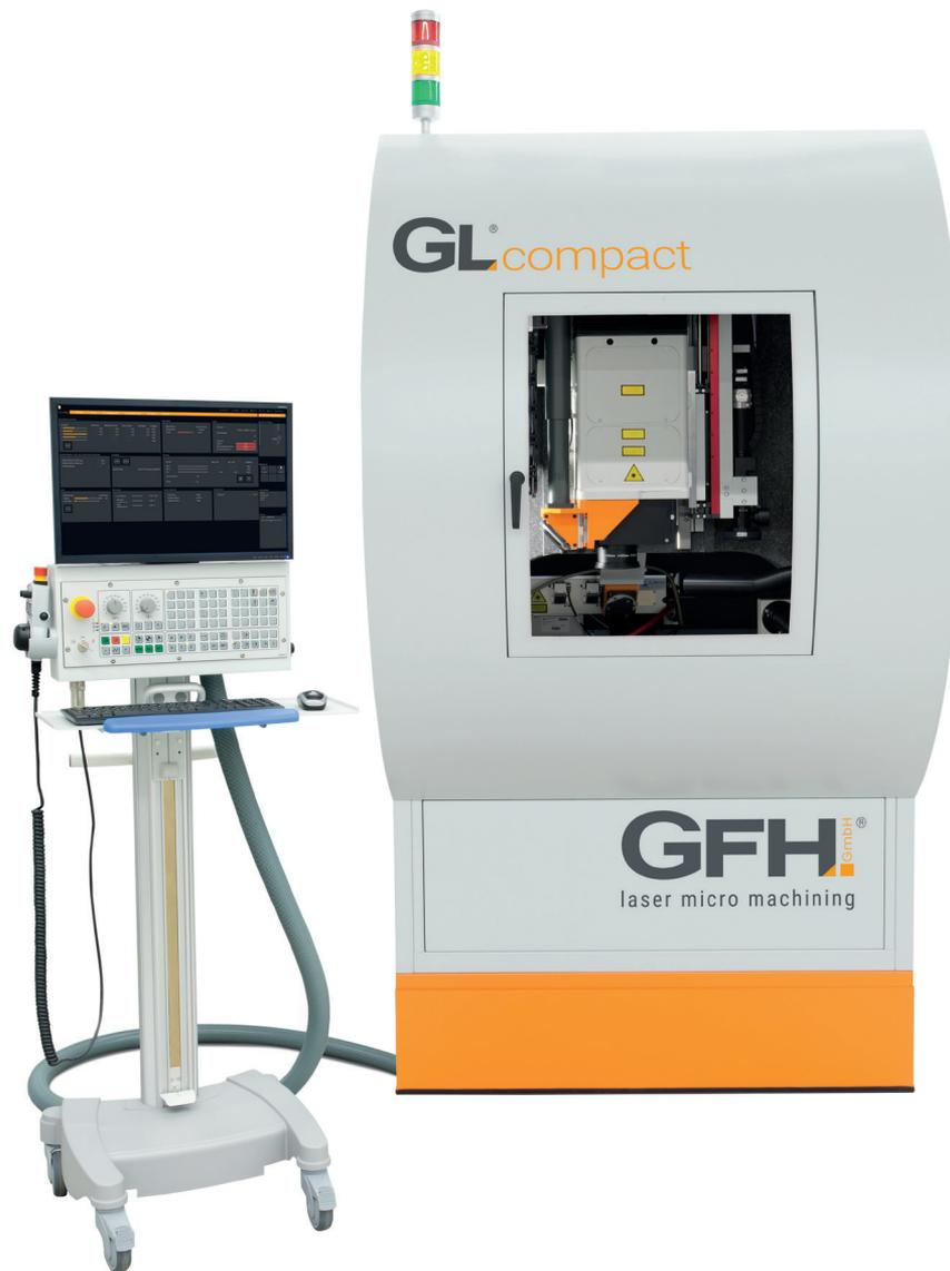
Die industrielle Lasermikrobearbeitungsanlage GLcompact ist auf Anwendungen ausgelegt, die weniger eine hohe Dynamik, als vornehmlich eine zuverlässige Positionierung des Werkstücks zur weiteren Bearbeitung mittels Scanner- oder Wendelbohroptik benötigen.
